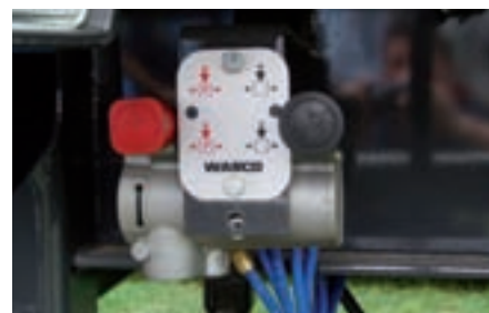
Brysselventilen är den röda. Instruktionerna är tydliga och lätta att förstå.
